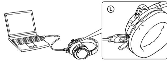
Uzlādēšana sākas, kad ierīce ir pieslēgta pie datora. Uzlādēšana tiek pabeigta maksimāli pēc apmēram 6 stundām, un automātiski nodzīst indikators (sarkans).
