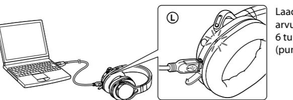
Laadimine alga, kui seade on ühendatud arvutile. Laadimine lõppib maksimaalselt 6 tunni pārāst ja laadimise indikator (punane) kustub.
