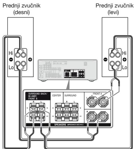
Povežite priključnice na Lo (ili Hi) strani prednjih zvučnika sa priključnicama SPEAKERS FRONT A, i povežite priključnice na Hi (ili Lo) strani prednjih zvučnika sa priključnicama SPEAKERS SURROUND BACK/BI-AMP/FRONT B.
