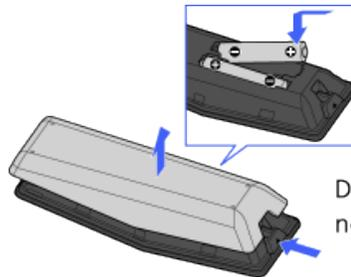
Drücken Sie die Entriegelungstaste und nehmen Sie die Abdeckung ab.
