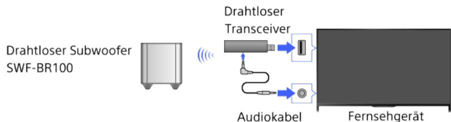
1. Schließen Sie das Audiokabel (mitgeliefert) an den drahtlosen Transceiver an.
