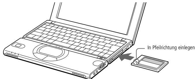
⚠ Wenden Sie beim Einsetzen einer PC Card keine Gewalt an. Die Kontaktstifte könnten beschädigt werden. Falls Sie beim Einsetzen einer PC Card Schwierigkeiten haben, prüfen Sie, ob das Etikett nach oben zeigt. Informationen über die Installation und Benutzung finden Sie im Handbuch Ihrer PC Card.
