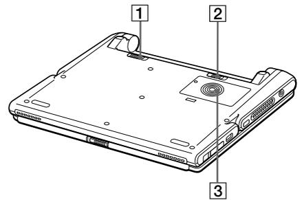
**1** Akku-Verriegelungshebel (Seite 19)    **2** Akku-Entriegelungshebel (Seite 19)    **3** Lüftungsschlitze
