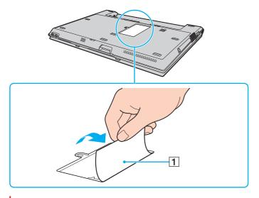
La lamina isolante viene fornita per la protezione del modulo. Evitare di tirarla troppo forte per non danneggiarla.
