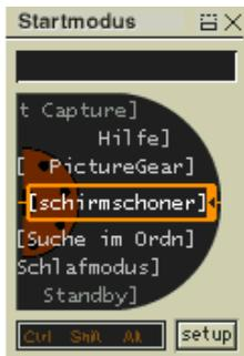
Das Jog-Dial-Fenster schaltet in den Anleitungsmodus um, wenn Sie eine Anwendung starten und deren Fenster aktiv wird. Abhängig von der jeweiligen Anwendung werden im Jog Dial-Fenster unterschiedliche Menübefehle angezeigt, die Sie durch Drehen oder Drücken des Jog Dials auswählen oder ausführen können.
