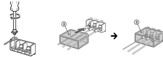
Provucite kabele kroz čep, spojite ih i zatim zatvorite priključke čepom.
