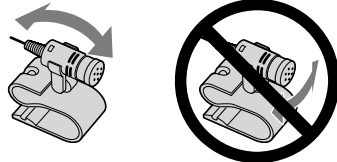
يدور الميكروفون على محور واحد، كما مبين في الشكل التوضيحي أدناه. لا تدره في الاتجاه الخاطئ بقوة.
