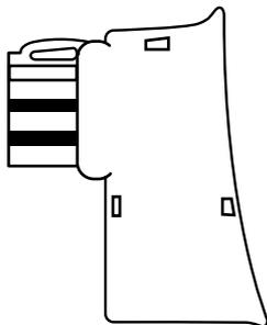
Nehmen Sie den Telefonsteckeradapter mit dem kleineren Kopf, der auf der Rückseite nicht mit einem weißen Dreieck versehen ist. Bringen Sie den Steckeradapter am Telefonkabel an.
