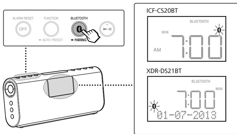
Pritisnite i zadržite dok se ne začuju zvučni signali i dok ne počne brzo treperiti "B" (Bluetooth)".
