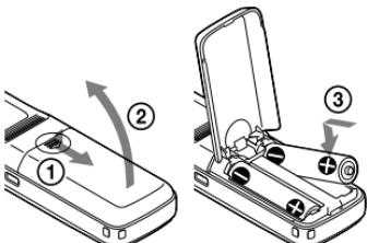
Ako se pokrov baterijskog pretinca slučajno odspoji, pričvrstite ga na način prikazan slikom.
