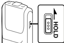
Pomaknite preklopku HOLD u suprotnom smjeru od strelice. IC rekorder se uključuje i treperi "ACCESS".
