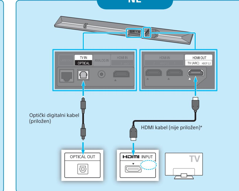
\* Da biste uživali u slikama formata 4K/60p, preporučuje se korištenje jednog ili više Premium HDMI kabela velike brzine s Ethernetom. Pojedinosti potražite u odjeljku „Vrste datoteka koje se mogu reproducirati“ u Uputama za upotrebu (zasebni dokument).
