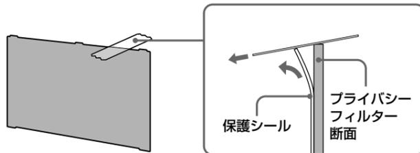
3 ディスプレイ上部の溝に、プライバシーフィルターをはめ込む。プライバシーフィルターの上側は、両端および中央の合計3か所に突起がある長辺です。
