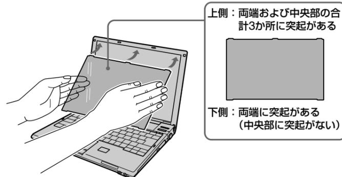
上側：両端および中央部の合計3か所に突起がある
