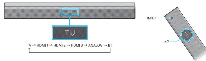
Pritisnite dugme INPUT dok se na displeju ne označi željeni ulazni uređaj. Pritisnite, zatim, dugme (jačina zvuka) da biste prilagodili jačinu zvuka.
