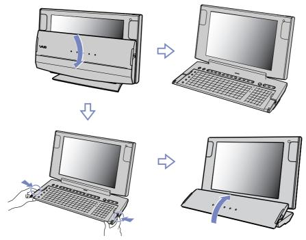
Mit der Software **Keyboard Closure Setup**, die auf Ihrem Computer installiert ist, startet der Computer beim Umklappen der Tastatur von einer Position in die andere die entsprechende Softwareanwendung.
