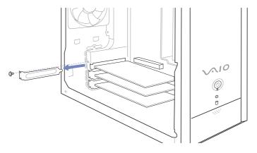
Installieren Sie die Hardwarekarte, indem Sie sie in den Steckplatz hineinstecken und anschließend mit der Schraube der Steckplatzabdeckung wie angezeigt.
