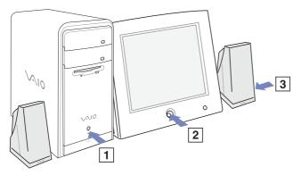
Wenn Sie den Netzschalter länger als sechs Sekunden drücken, wird der Computer automatisch abgeschaltet.
