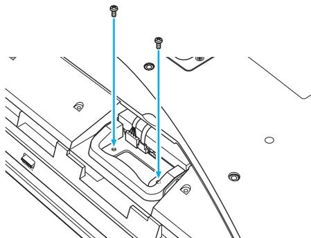
13 Установите на место крышку отсека жесткого диска и затяните винты.
