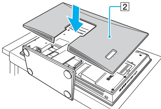
**!** Крышка задней панели и крышка стойки должны всегда находиться на компьютере. Снимать их можно для обеспечения доступа к задней панели.
