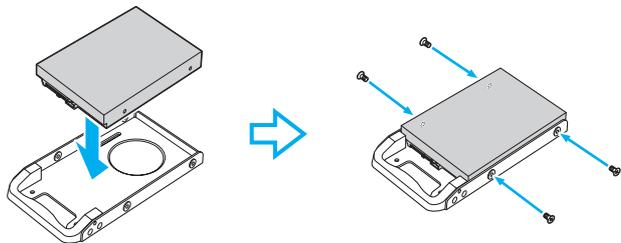
! Un nouveau disque dur est livré avec les vis nécessaires. Ne serrez pas de manière excessive ces vis lors de la fixation du lecteur à son support.
