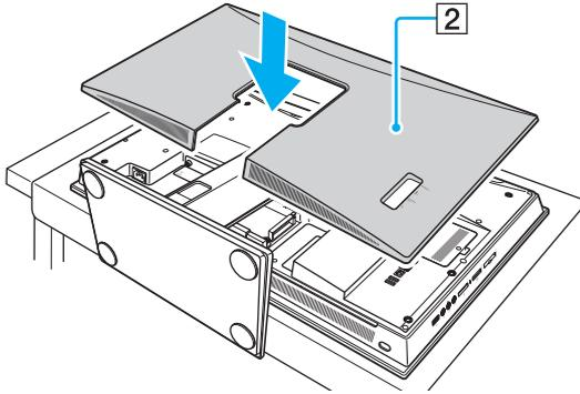
! Deje la cubierta del panel posterior y la cubierta del soporte en el ordenador a menos que sea necesario acceder al panel posterior.
