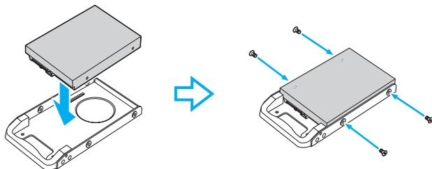
! Las unidades de disco duro nuevas vienen con los tornillos necesarios. No apriete demasiado los tornillos al fijar la unidad a su soporte.
