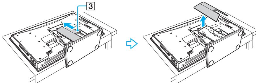
Para colocar la cubierta del panel posterior y la cubierta del soporte de la base
