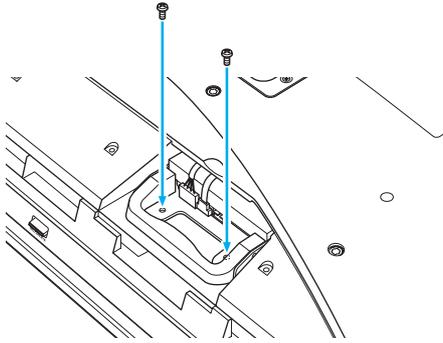
13 Vuelva a colocar la cubierta del compartimento de la unidad y apriete los tornillos.
