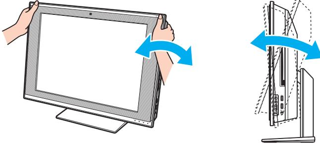
! Al ajustar el ángulo de visión, no ejerza una presión excesiva en el ordenador, en especial en la parte central de los altavoces, con el fin de evitar el riesgo de daño mecánico.
