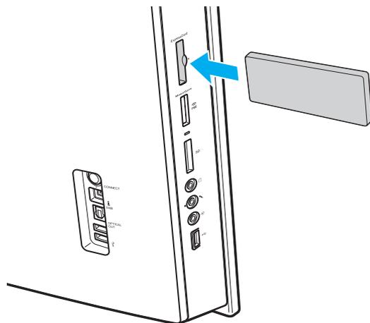
! Quando non si utilizza un modulo ExpressCard, inserire la protezione per lo slot ExpressCard in modo da proteggerlo dalla polvere. Prima di spostare il computer, assicurarsi di inserire la protezione nello slot per ExpressCard.
