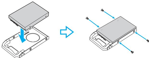
! I nuovi dischi rigidi vengono forniti con le viti necessarie. Non serrare eccessivamente le viti durante il fissaggio dell'unità all'apposito supporto.
