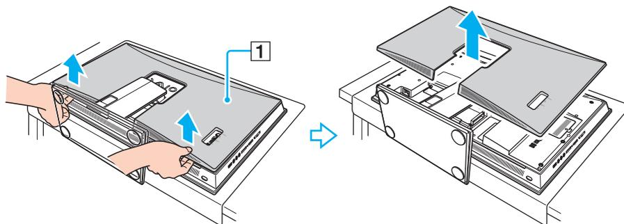
! Infilare la punta delle dita sotto il coperchio del pannello posteriore (2) mentre si rimuove il coperchio dal computer.
