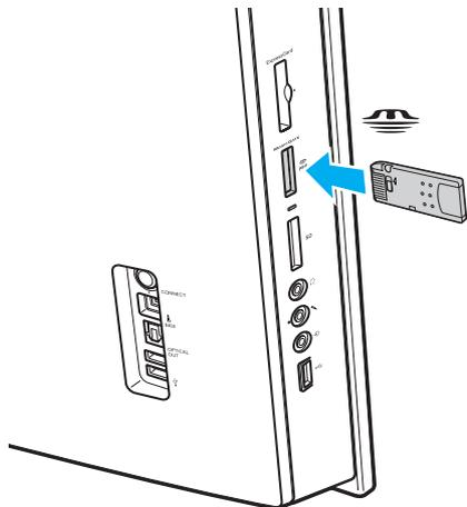
! Quando si inserisce il Memory Stick nello slot, mantenere la freccia puntata nella direzione corretta. Per evitare di danneggiare il computer o il Memory Stick, non forzare quest'ultimo se l'inserimento nello slot risultasse difficile.
