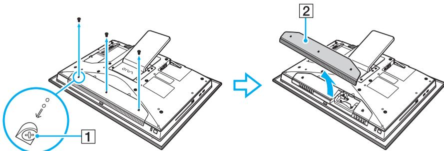
6 Отверните три винта (3) крепления жесткого диска.
