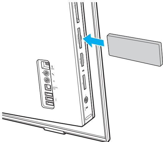
! Если модуль ExpressCard не используется, вставьте в гнездо ExpressCard защитное устройство, которое препятствует попаданию в гнездо пыли и грязи. Перед перемещением компьютера обязательно вставьте защитное устройство в гнездо ExpressCard.
