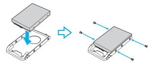
Die erforderlichen Schrauben sind Im Lieferumfang von neuen Festplattenlaufwerken enthalten. Ziehen Sie diese Schrauben nicht zu fest an, wenn Sie das Laufwerk an der Laufwerkshalterung befestigen.
