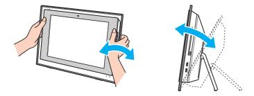
Üben Sie beim Einstellen des Betrachtungswinkels keinen übermäßigen Druck auf den Computer aus, insbesondere nicht auf die Mitte der Lautsprecherabdeckung. Andernfalls besteht das Risiko eines mechanischen Schadens.
