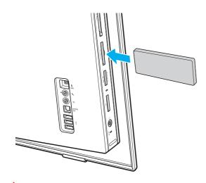
Setzen Sie die ExpressCard-Transportsicherung ein, um zu verhindern, dass Schmutz in den Steckplatz eindringt, wenn kein ExpressCard-Modul verwendet wird. Vergewissern Sie sich vor dem Transportieren des Computers, dass die Transportsicherung in den ExpressCard-Steckplatz eingesetzt ist.
