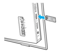
Ächten Sie beim Einsetzen des Memory Sticks in den Steckplatz darauf, dass der Pfeil in die richtige Richtung zeigt. Wenn sich der Memory Stick nicht leicht einsetzen lässt, drücken Sie ihn auf keinen Fall mit Gewalt in den Steckplatz. Ihr Computer oder der Memory Stick könnte sonst beschädigt werden.
