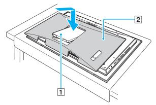
2 Richten Sie die Abdeckung an der Rückseite des Computers aus, und drücken Sie sie gegen den Computer.
