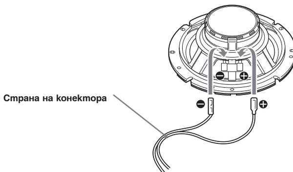
В зависимост от модела на автомобила, използвайте специален конектор (не е приложен в комплекта). Вижте монтажния пример за повече подробности.
