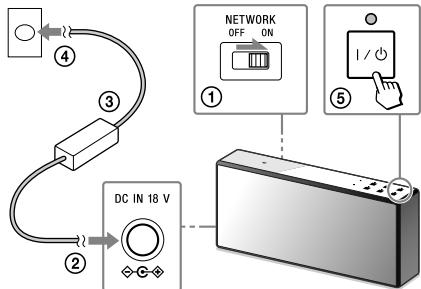
Veenduge, et NETWORK OFF/ON läiti on seadistatud ON, siis lülitage seade sisse. Kui kustub LINK indikaator, minge üle järgmissele toimingule.
