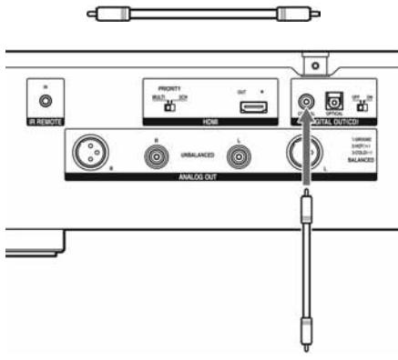
U CD koaksijalnu digitalnu ulaznu priključnicu na MD uređaju, itd.
