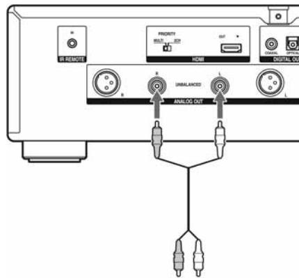
U CD (Super Audio CD) ili analogne ulazne priključnice (L/R) stereo pojačala, MD uređaja, itd.
