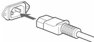
Između priključka i stražnje ploče ostane malo slobodnog mesta čak i kad je mrežni kabel čvrsto spojen. Kabel treba biti spojen na taj način.
