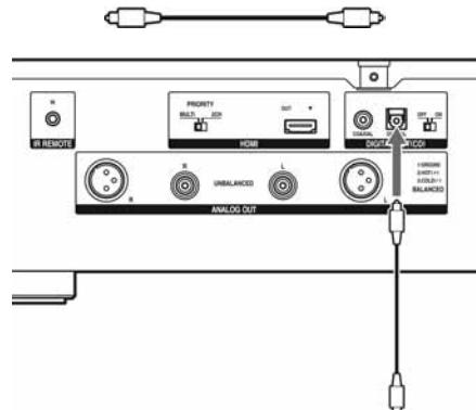
U CD optičku digitalnu ulaznu priključnicu na MD uređaju, itd.
