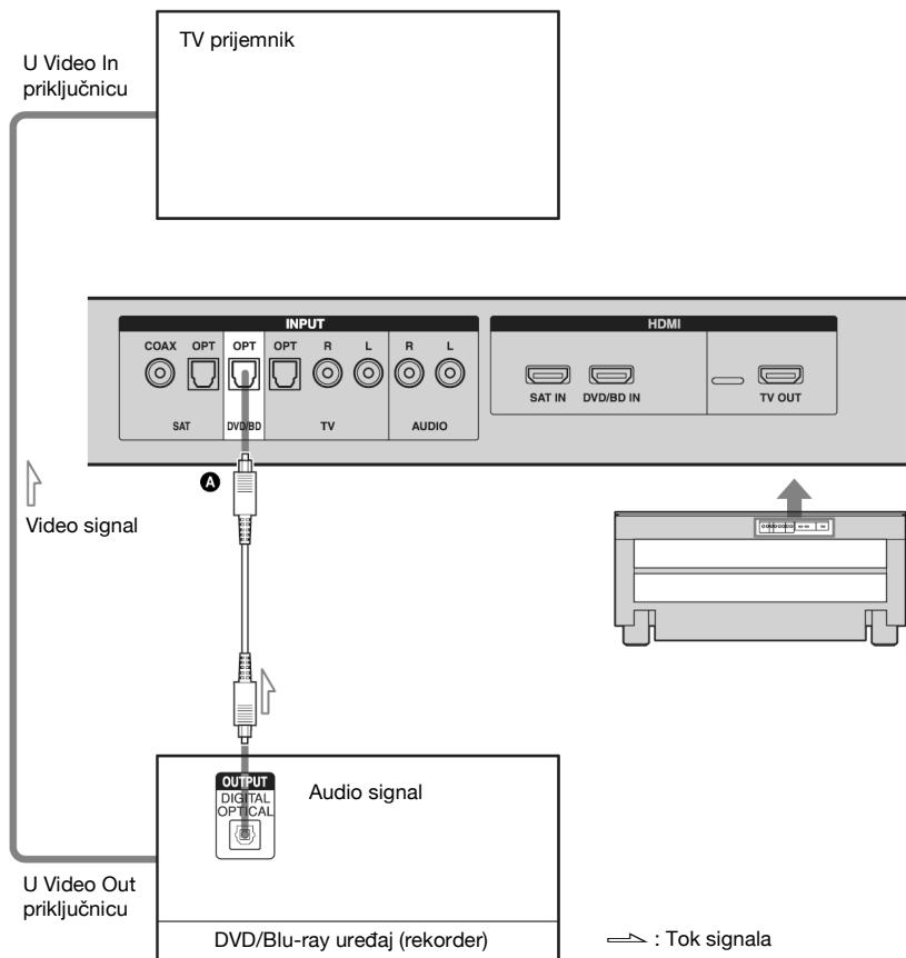
Ⓐ Optički kabel (nije isporučen)
