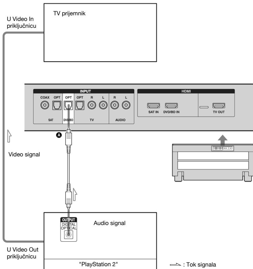
Ⓐ Optički kabel (nije isporučen)
