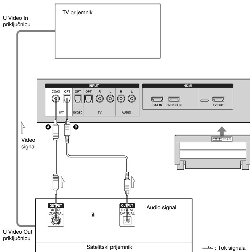
**A** Koaksijalni digitalni kabel (nije isporučen)
