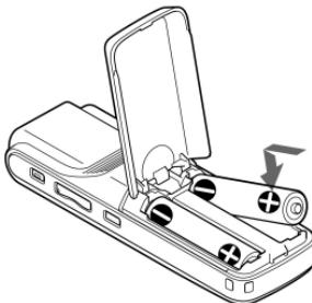
Ako se pokrov baterijskog pretinca slučajno odspoji, pričvrstite ga na način prikazan slikom.
