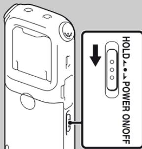
Pomaknite preklopku HOLD•POWER ON/OFF prema sredini.
