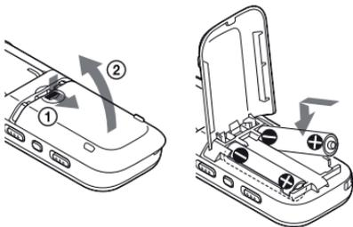
Ako se poklopac sandučeta za baterije slučajno odspoji, pričvrstite ga na način prikazan slikom.
