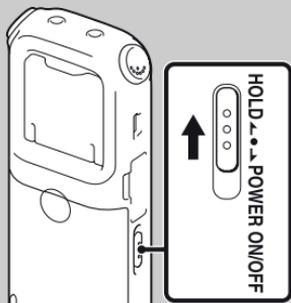
Pomaknite preklopku HOLD•POWER ON/OFF u smjeru "HOLD".
