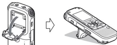
Ako se nožica slučajno odspoji, pričvrstite je na način prikazan slikom.
