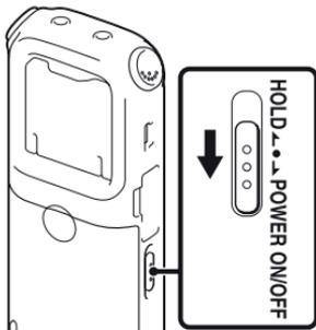
Pomerite preklopku HOLD•POWER ON/OFF u smeru "POWER ON/OFF" duže od jedne sekunde. IC rekorder se uključuje i prikazuje se animacija "Accessing...".
