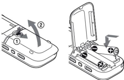
Ako se pokrov baterijskog pretinca slučajno odspoji, pričvrstite ga na način prikazan slikom.
