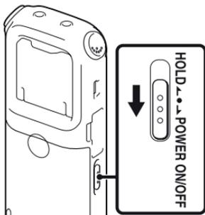
Pomaknite preklopku HOLD•POWER ON/OFF u smjeru "POWER ON/OFF" dulje od jedne sekunde. IC rekorder se uključuje i prikazuje se animacija "Accessing...".
