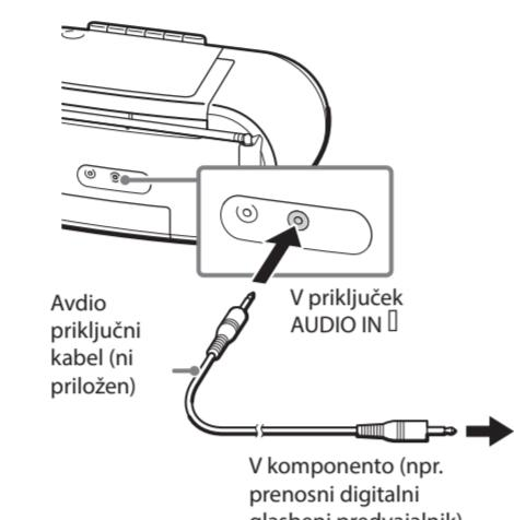
1 Z avdio priključnim kablom (ni priložen) povežite priključek AUDIO IN [16] na enoti z linijskim izhodnim priključkom na prenosnem digitalnem glasbenem predvajalniku ali drugi komponenti.
