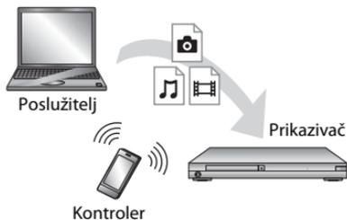
Upravlajte ovom jedinicom pomoću DLNA kontrolera. Pročitajte priručnik s uputama isporučen s DLNA kontrolerom.
