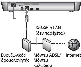
Συνιστάται η χρήση θωρακισμένου καλωδίου διεπαφής (καλώδιο δικτύου LAN), ευθείας σύνδεσης.
