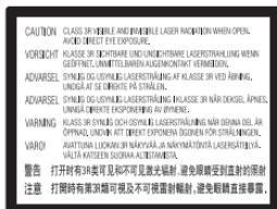
Questa etichetta si trova sull'alloggiamento di protezione del laser all'interno del rivestimento.
