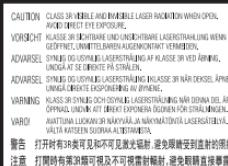
Cette étiquette est située sur le capot de protection du laser, à l'intérieur du boîtier.
