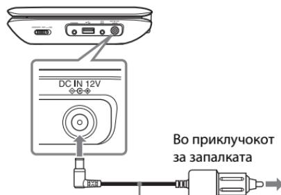
Адаптер за приклучување со акумулаторот во автомобилот (се доставува)
