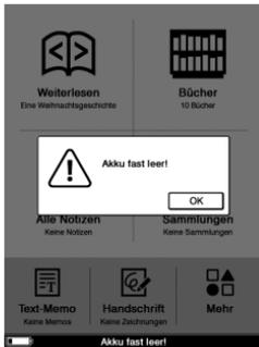
Verwenden Sie das Gerät weiterhin ohne Laden, erscheint folgende Warnung, und der Reader wird automatisch ausgeschaltet.
