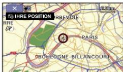
Die aktuelle Position wird in der Mitte des LCD-Bildschirms angezeigt und markiert. Wenn Sie eine bestimmte Stelle auf dem Bildschirm berühren, wird diese Stelle bei der Anzeige des Gebiets auf der Landkarte in die Mitte gerückt.
