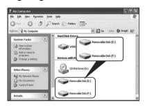
Laufwerksbuchstaben für die Wechseldatenträgersymbole werden in alphabetischer Reihenfolge dem "Memory Stick"-Einschub und dem MultiMediaCard-/SD Memory Card-Einschub zugewiesen. Wenn der Computer vor dem Anschließen des Lese-/Schreibgeräts z. B. über die Laufwerke A:, C: und D: verfügt, werden beim Anschließen des Lese-/Schreibgeräts die folgenden Laufwerksbuchstaben zugewiesen:
