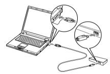
Der Computer erkennt das Lese-/ Schreibgerät als Wechseldatenträger und danach ist das Lese-/Schreibgerät einsatzbereit.
