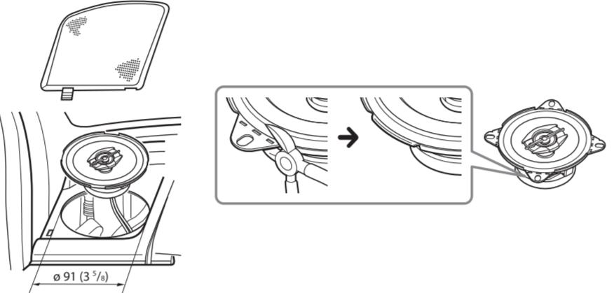
Ukoliko se uklone montažni nosači, zvučnik je moguće ugraditi u gotovo bilo koji tip vozila. Kleštimi ili sličnim alatom odrežite dva montažna nosača tako da sa ruba okvira zvučnika ništa ne vira, kako je prikazano na crtežu.
