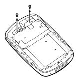
6 Ziehen Sie das Anschlusskabel zwischen Akku und Player ab, um die Anschlüsse zu trennen.
