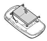
6 Ziehen Sie das Anschlusskabel zwischen Akku und Player ab, um die Anschlüsse zu trennen.
