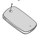
3 Schieben Sie die Rückenabdeckung des Players herunter, und heben Sie sie an, wie unten durch den Pfeil dargestellt.
