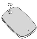
2 Schieben Sie die Rückenabdeckung des Players herunter, und heben Sie sie an, wie unten durch den Pfeil dargestellt.
