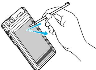
Zum Öffnen einer Anwendung oder Auswählen eines Menüpunkts berühren Sie das gewünschte Symbol oder den Menüpunkt auf dem Bildschirm leicht mit der Stiftspitze (siehe Abbildung).
