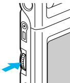
Drücken Sie den Jog Dial™, um das Element hervorzuheben oder die Anwendung auszuführen, die Sie durch Drehen des Jog Dial™ ausgewählt haben. Es hängt von der von Ihnen verwendeten Anwendung ab, welche Vorgänge durch das Drücken des Jog Dial™ durchgeführt werden können. Weitere Informationen hierzu finden Sie in den Anleitungen zu den einzelnen Anwendungen.
