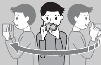
Панорамируйте камеру по дуге с постоянной скоростью в направлении, показываемом на ЖК-экране, учитывая следующие моменты. В сравнении с обычной скоростью панорамного обзора, скорость при панорамировании 3D должна быть в два раза ниже.
