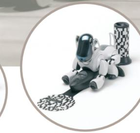
AIBO sucht seine Ladestation selbständig auf, wenn seine Energie nachlässt. Anhand des Musters auf dem Turm der Ladestation kann sich AIBO orientieren und selbständig positionieren.
